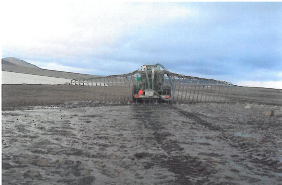
Mynd 21 Rykbindiefni dreift með traktor sem búinn er sérstökum dreifara.
