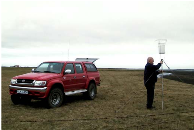
Hreggviður M Jónsson umsjónarmaður með fallryksmælum undirbýr að skipta um söfnunarílát í mæli. 15. júní 2005
