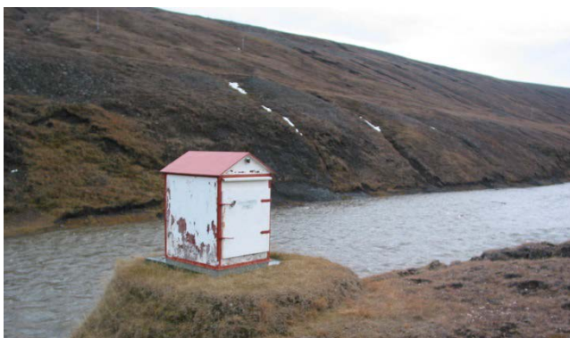
Mynd 17. Vatnshæðarmælir V288 í Hrafnkelu. Ljósmynd Egill Axelsson.
