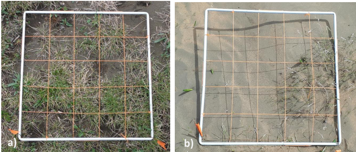
Mynd 1. Mælireitur AM021_02 við austurströnd Háslóns þar sem mesta áfoksþykktin mældist 2019. Mynd a) frá 9. júlí 2015, meðalþykkt áfoks 1,2 cm. Mynd b) frá 3. júlí 2019, meðalþykkt áfoks 5,5 cm.
