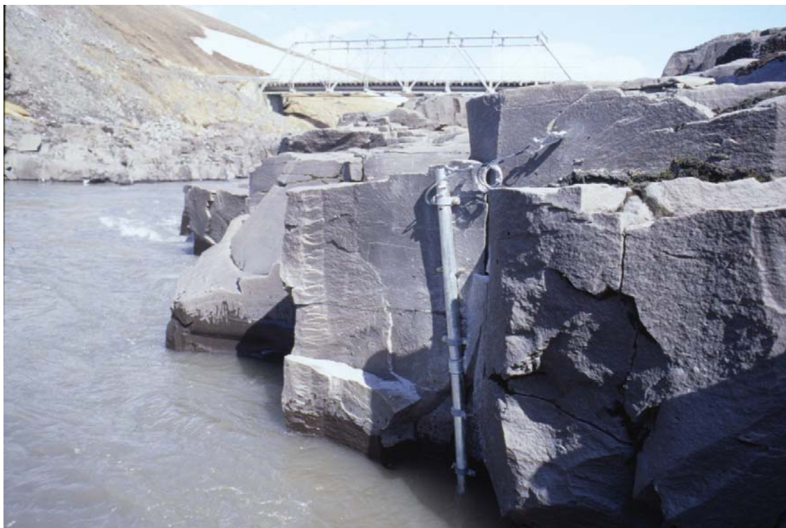
Mynd 4. Hitamælirinn í Jökulsá á Dal við Brú var á 0,9-2 m dýpi rétt ofan við brúna (ljósmynd Landsvirkjun, VKH).
